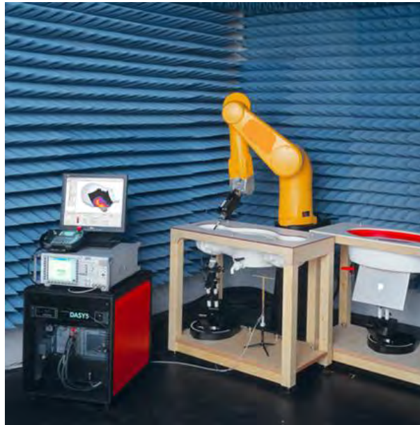
Figura 1: Um sistema de medição de SAR de cabeça e corpo composto pelo phantom, braço robótico com sonda calibrada e uma unidade de pós-processamento. [Fonte: Rec. K.91]
